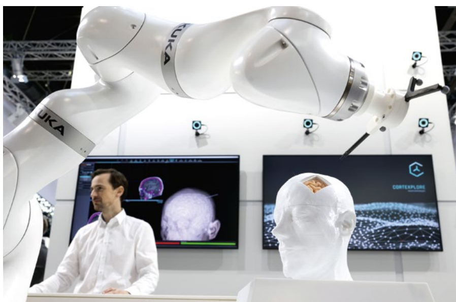
Robot LBR Med od společnosti KUKA může být významným pomocníkem například při operacích mozkových nádorů. Speciální software Cortexplore umožňuje sledování průběhu operace v reálném čase (obrazovky v pozadí).
