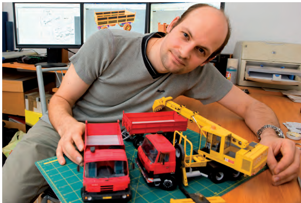
Skupina nákladních automobilů, které se mohou „potkat“ na každé větší stavbě – sklápěč Tatra 815 S3 s vlekem BSS a autobagr Tatra 815 UDS 114. Autobagr, jak je vidět, má pohyblivou nástavbu, rameno i výměnné lžice. Tak jako ve skutečnosti, jsou i na modelu dva motory – jeden pod kabinou, druhý vzadu, v nástavbě. | Foto: Leoš Chodura
