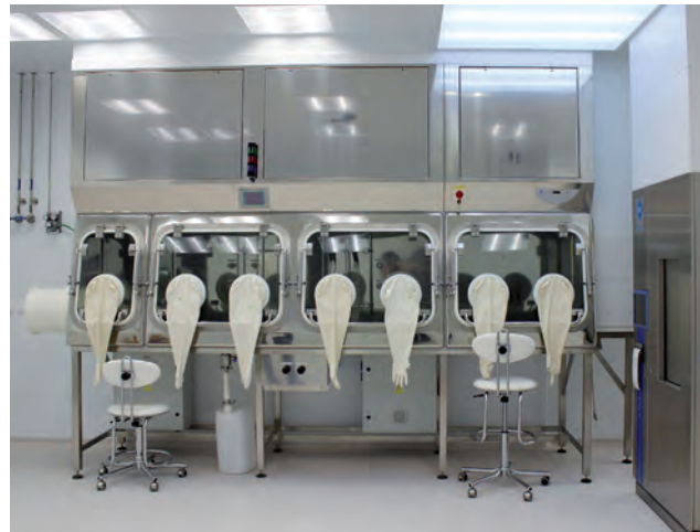
Příklad izolátorového pracoviště s rukávcovými boxy. | Vizualizace: IKEM
