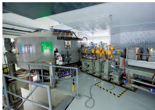
V cyklotronu se protony urychlují a poté letí do ozařoven. | Foto: archiv PTC
