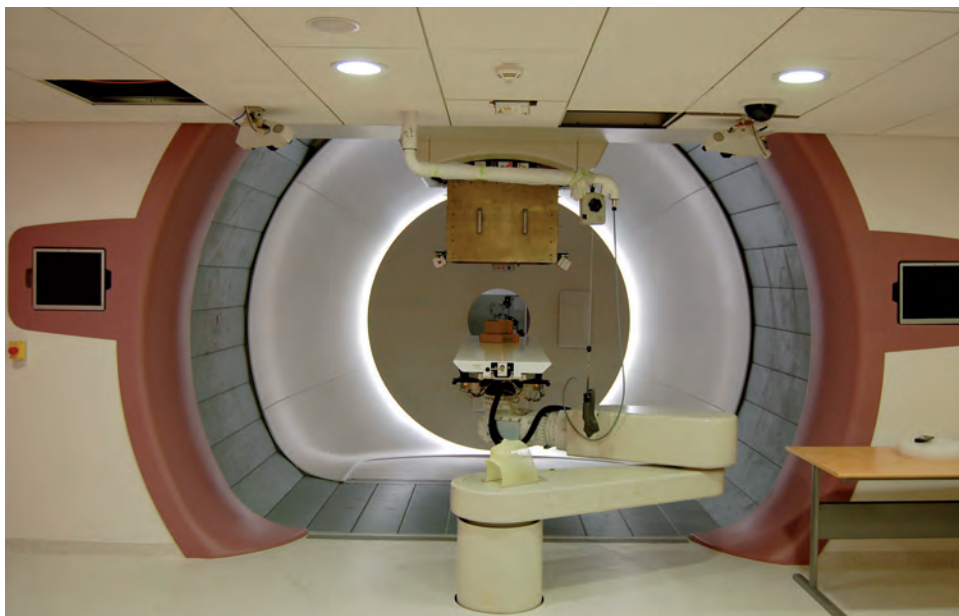
Ozařovna s otočnou tryskou na velkém gantry, jež umožňuje pohyb o 360 stupňů. | Foto: Martin Čermák
